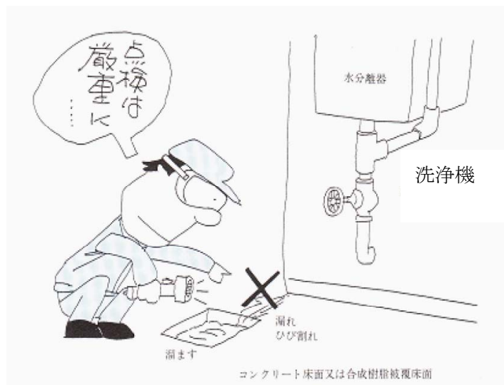
施設の点検例
