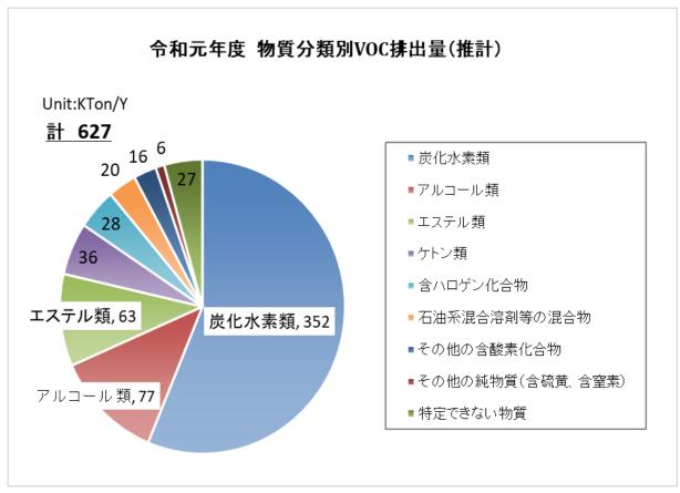
塩素系溶剤は、含ハロゲン化合物に該当し、ジクロロメタン、トリクロロエチレン、 テトラクロロエチレン他(フッ素系、臭素系を含む)がここに推計されています。
